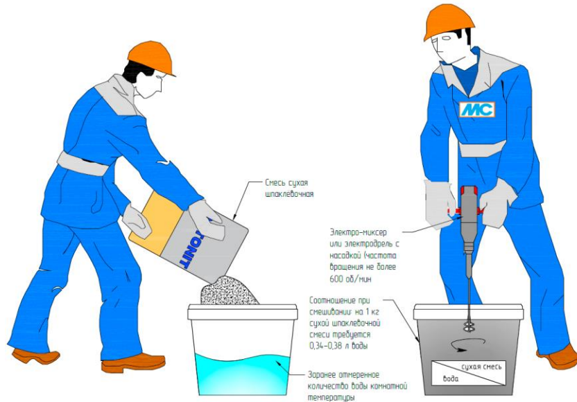
Рис. 22. Организация работ по затворению сухой шпаклевочной смеси
